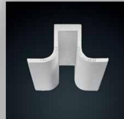
Der Gipseinbaukanal mit abgerundeten seitlichen Kanten verleiht der linearen Beleuchtung einen sanften Touch. Er wird bündig in die Gipskartondecke eingebaut, die passgenaue Leuchte – optional mit T16 Leuchtstofflampe oder LED bestückt – verschwindet komplett hinter der satinierten oder prismatischen Acrylabdeckung. Wie alle linearen Beleuchtungssysteme, ist auch TZ-50 | TZ-51 in der Länge absolut flexibel.
