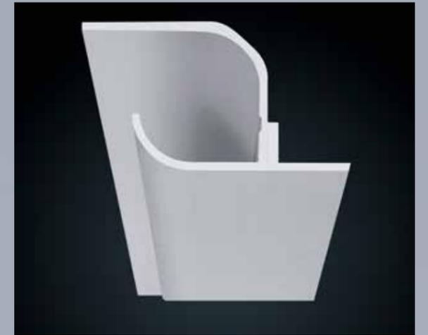
Besonders in großen Räumen ermöglicht das Voutensystem eine kreative Deckengestaltung. Die Voutenelemente aus Gips mit abgerundeten Konturen werden randlos in Gipskartondecken eingebaut und bilden eine homogene und schattenfrei ausgeleuchtete Lichtvoute ohne sichtbare Ecken oder Kanten. Aus Geraden und Viertelbögen mit unterschiedlichen Radien lassen sich Kreise, Ovale oder andere freie Formen gestalten. Bei einer Bestückung mit RGB-LED sind auf Wunsch farbige Lichteffekte möglich.
